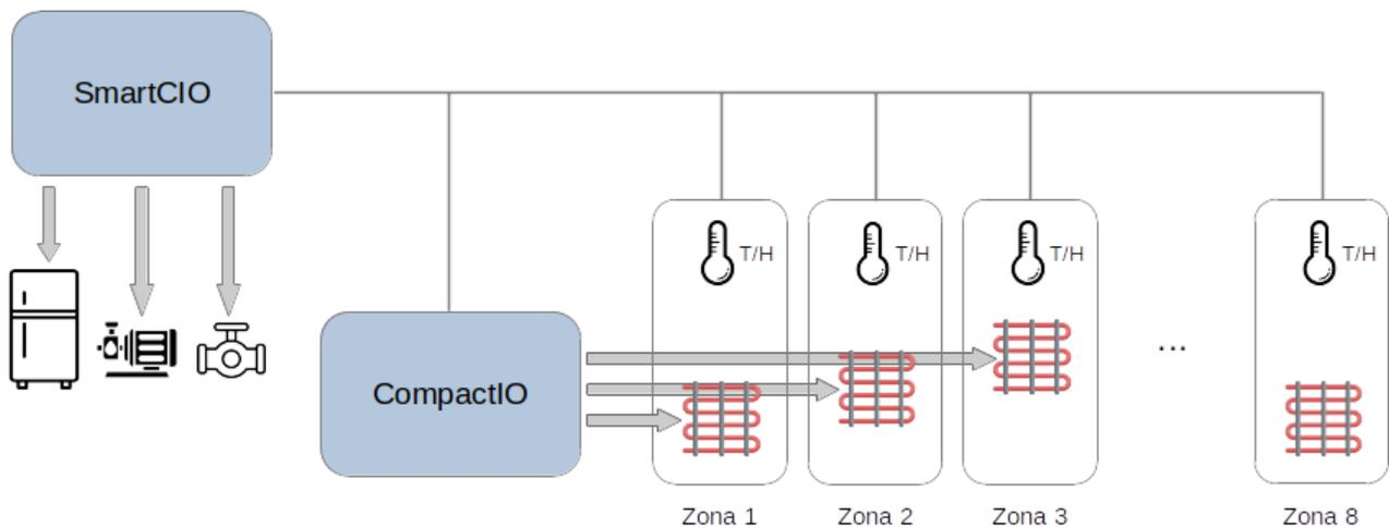
Con questa tipologia di installazione si controlla l'umidità e il radiante di ogni zona in caldo e freddo tramite un **relè della scheda CompactIO**. Le misure di temperatura e umidità dell'ambiente sono fornite dalle sonde T/H.
