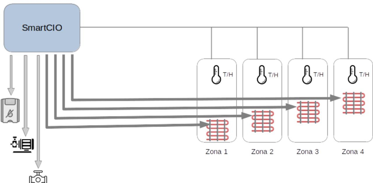
Con questa tipologia di installazione si controlla l'umidità e il radiante di ogni zona in caldo e freddo tramite un **relè della Smart CompactIO**. Le misure di temperatura e umidità dell'ambiente sono fornite dalle sonde T/H. Possono essere gestite al massimo **4 zone** con **circuito idraulico unico**. Non viene gestito il generatore e l'integrazione del deumidificatore.
