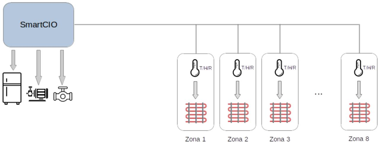
Con questa tipologia di installazione si controlla l'umidità e il radiante di ogni zona in caldo e freddo tramite il relè a bordo della scheda T/H/R che fornisce anche le misure di temperatura e umidità dell'ambiente.
