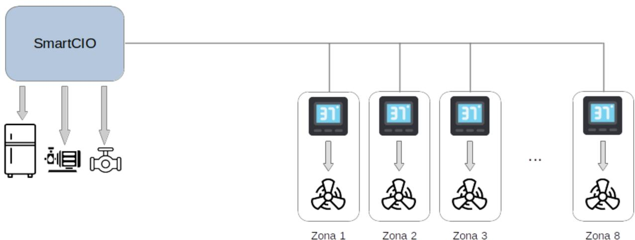
Con questa tipologia di installazione si controlla il fan coil di ogni zona in caldo e freddo tramite i relè a bordo del terminale ROOM/MINI-TOUCH che fornisce anche la misura di temperatura dell'ambiente.
