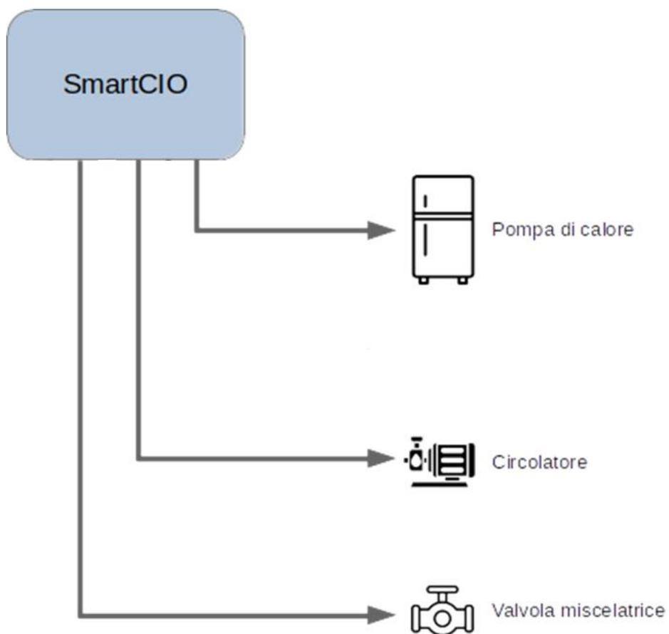
In questo scenario l'accensione della pompa di calore e del circolatore non può essere controllata dalle chiamate delle zone, che non sono presenti, è invece controllata da una programmazione oraria che può essere impostata tramite app "Termogea".
