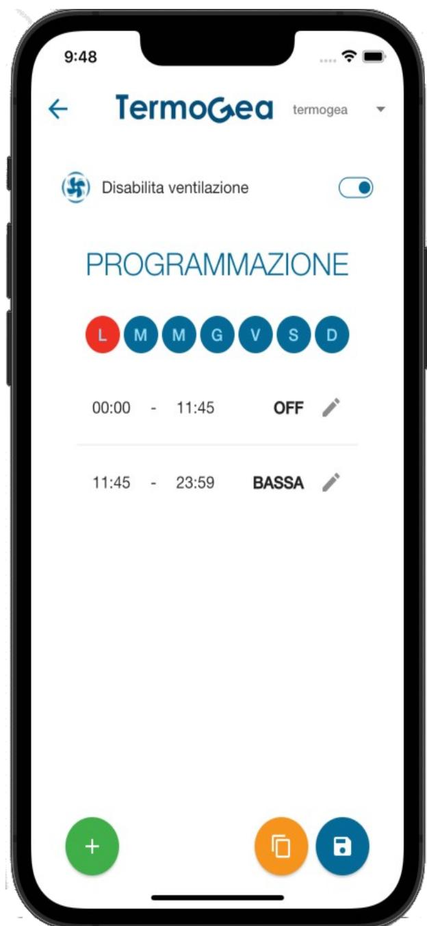
La programmazione della ventilazione meccanica è supportata dal cloud solo se si dispone almeno della versione del firmware 5.8 sulla centralina.
