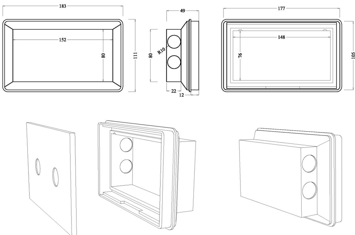
⚠ Effettuare i collegamenti elettrici prima di inserire il Pannello Touch nell'alloggiamento filo-muro.
