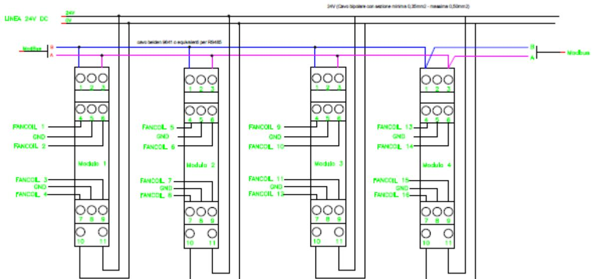
**IMPORTANTE:** Collegare una resistenza di **120 ohm** fra A e B dell’ultimo dispositivo modbus connesso nel bus.
