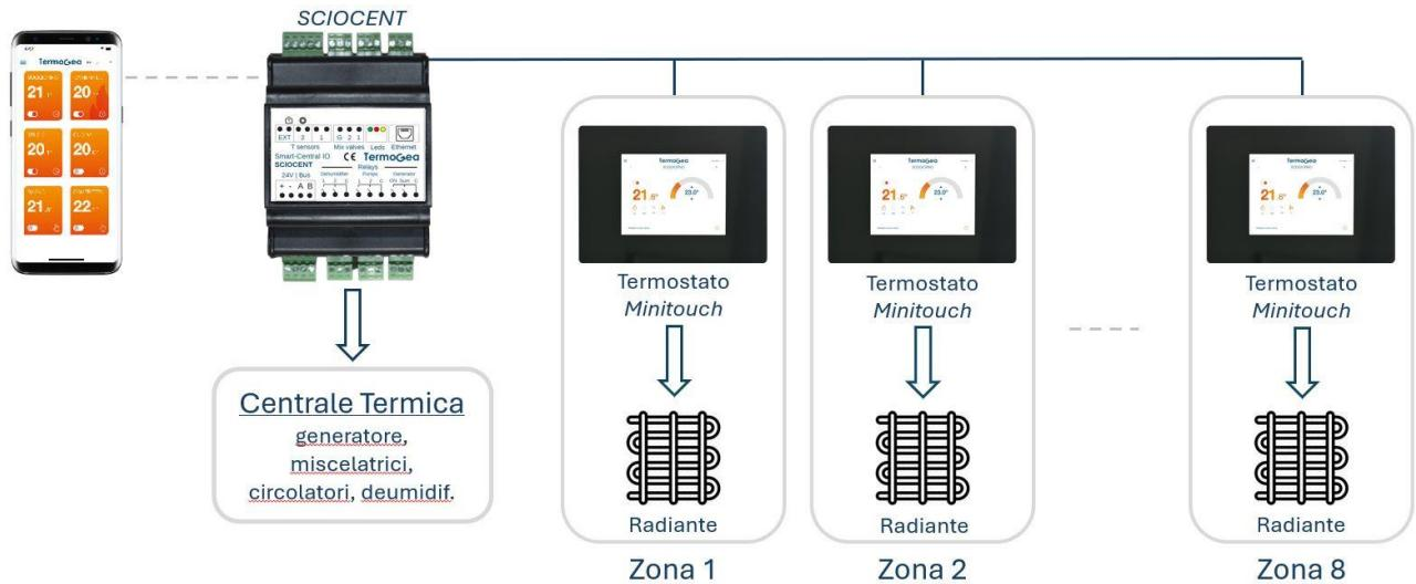
Anche con questa tipologia di installazione si controllano sia la temperatura che l'umidità in ogni zona, grazie alla sonda di umidità presente sul modulo T/H/R e alle uscite per il deumidificatore della centralina SCIOCENT.
