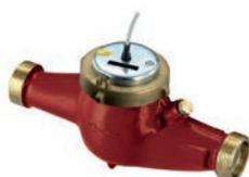
Contatori d'acqua calda sanitaria multigetto con emettitore Reed. ACS Meter MT è un contatore per acqua multigetto a quadrante asciutto, progettato per rispondere alle severe prescrizioni previste dalla Direttiva MID 2014/32/UE e dalla Norma europea ISO 4064. Ideale per la misurazione in utenze di media taglia. È dotato di un emettitore di impulsi per essere collegato ad elettroniche di comunicazione M-Bus.
