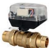
Valvole di zona a sfera a passaggio totale. Due vie motorizzate con servocomando (230 Volt o 24 Volt AC). Relè e micro ausiliario per contatto pulito. Connessioni a bocchettone. Pressione max d'esercizio 16 bar. Pressione differenziale max 10 bar. Temperatura d'esercizio max 110 °C.
