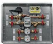
Termoregolazione ambiente e controllo della pressione differenziale del circuito termico d'utenza. Contabilizzazione dell'energia di riscaldamento, raffrescamento e acqua sanitaria calda e fredda con il controllo del circolo ACS. L'innovativa valvola di zona AB-PM HP mantiene costante la pressione differenziale del circuito termico in tutte le utenze dell'impianto, nonostante la presenza di variazioni dal lato montante.
