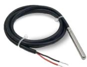
Sensori di temperatura digitali per pozzetti e tubazioni. Questi sensori sono in grado di effettuare misure di temperatura tra -55 e 125°C con una precisione di  $\pm 0,5$ . Ogni sensore è codificato con un indirizzo univoco a 64bit che permette l'utilizzo contemporaneo di più sensori sullo stesso bus di comunicazione.
